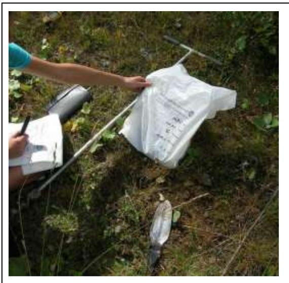
**Fig. 1** – Prelevamento di un campione di terreno da sottoporre ad analisi fisico-chimica.
